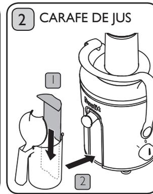
Insérez le filtre anti-mousse dans la carafe et placez la carafe complète sous le bec.
