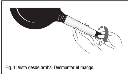
Sujete el mango con una mano y con la otra mano gire la punta del mango en sentido contrario a las agujas del reloj. Si es necesario, utilice un objeto largo, fino y resistente como el mango de una cuchara de madera o una brocheta e introdúzcalo por el agujero en la punta del mango para hacer palanca y facilitar el giro.
