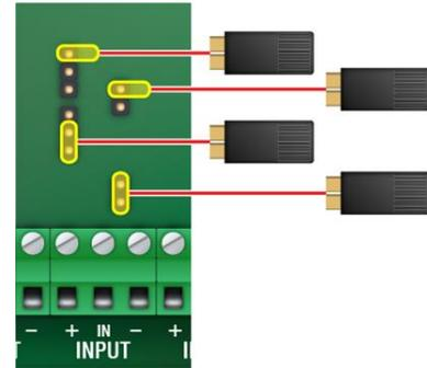
**Wiring for Phasón sensors**
