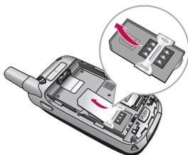
4. Placez les ergots sous la batterie à l'intérieur du support de retenue. Puis, appuyez sur la base de la batterie jusqu'à ce qu'elle soit bien en place (un clic sera audible).
