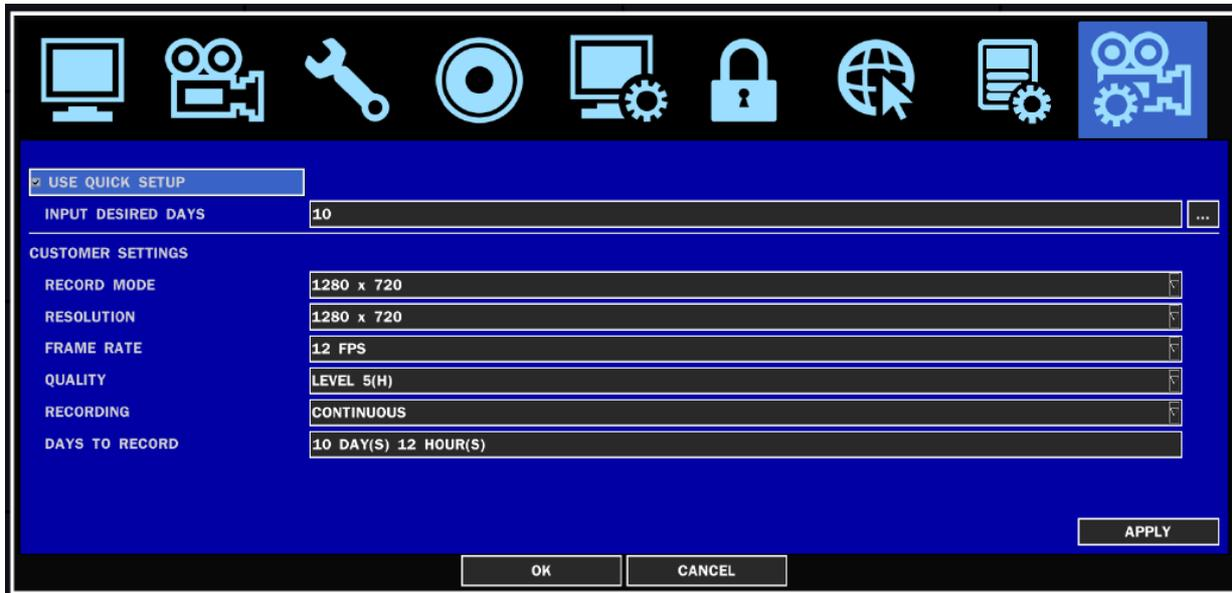
**Figure 2.10.1. Quick Setup Screen**
