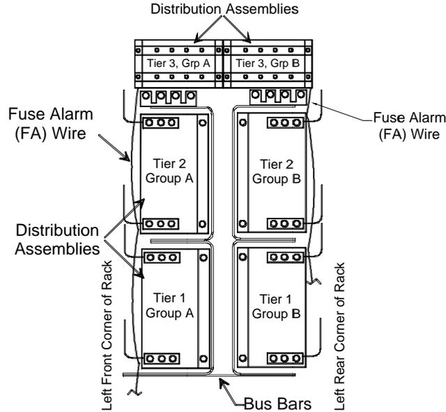
**FIGURE 2-11 GJ1 TYPE BREAKER DISTRIBUTION ASSEMBLIES, TYPICAL**
