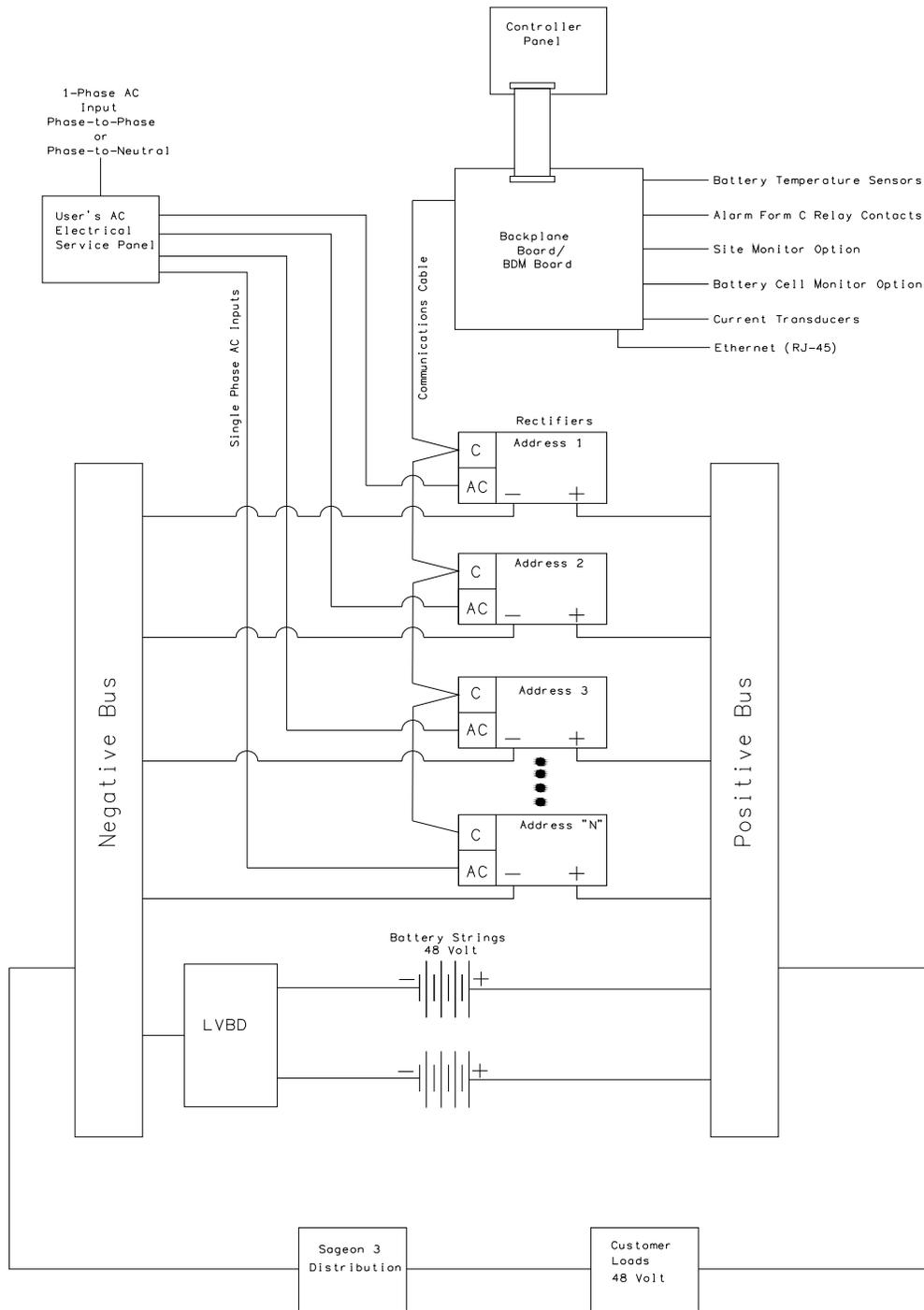
**FIGURE 1-2 SIMPLIFIED BLOCK DIAGRAM, -48V POWER SYSTEM**
