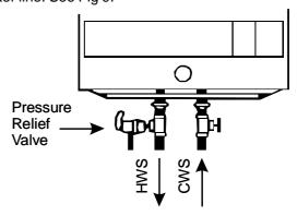
Fig. 9 - Pressure Relief Valve
