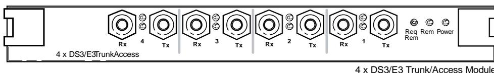
Figure 8. 4 x DS3/E3 Trunk/Access Module
