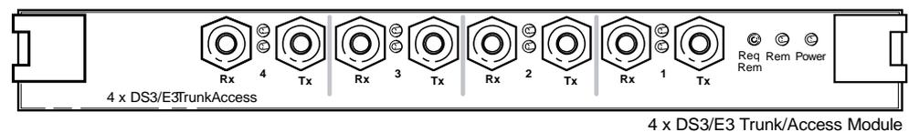
**Figure 16. 4 x DS3/E3 Trunk/Access Module**
