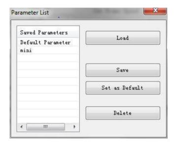
**Load:** load one parameter from the parameter list on the left.
