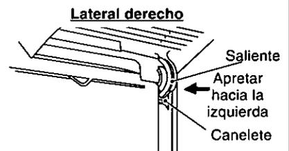
3. Liberar el eje del orificio de anclaje.
