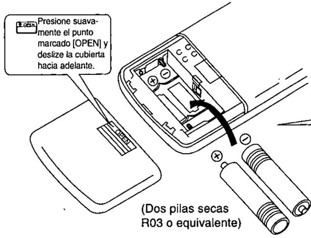
Presione suavemente el punto marcado [OPEN] y deslice la cubierta hacia adelante.
