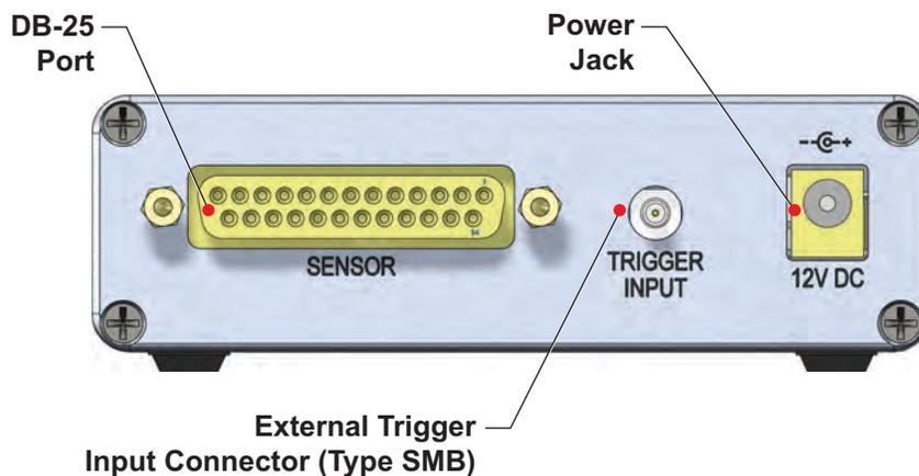
*Figure 3-2. Meter Back Panel*
