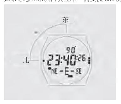
表盘上北方显示为一个条块,南方显示为三个条块。 表盘上的字母显示为当前方向(如 NW-N-NE)。 上侧显示为磁偏角值。所有显示值包括: 当前方位、当地磁场(指南针所指方向) 与地理北极之间的角度,即磁偏角。 当地磁北极在地理北极东面时,磁偏角值为正。 例如,"10"是指 地磁北极在地理北极逆时针 10 度的方向。
