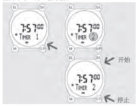
短按 S/L 键即可开始进行倒计时。倒计时最后为 0, 倒数 5 秒时会有嘟嘟声提醒。 到倒计至 0 时,复位为原始时间。 (除非设置为重新倒计时或开始下一次倒计时)。 数值范围:00:01:00 min — 23:59:00 hrs (可以显示到秒,但不能设置)。
