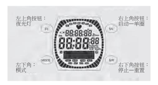
设置模式下,按S/L和S/R键可改变所有数值。 S/L数值增加,S/R数值减少。 (长按时可加速改变数值。)
