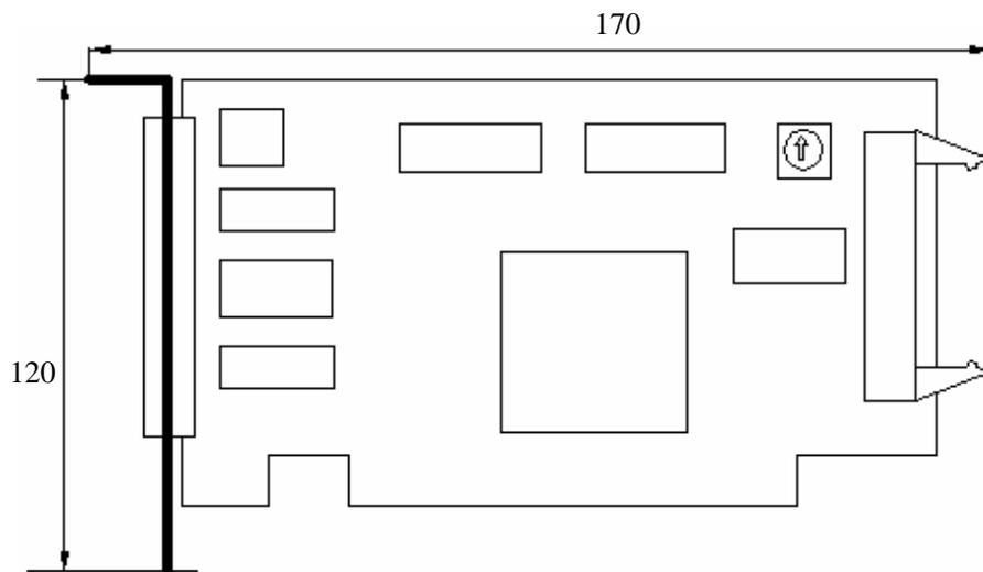
Fig. 2-2 MPC2810 Dimensions (mm×mm)
