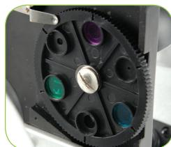
**DIAFRAGMA** - Dentro de la rueda del filtro dispone de tres diámetros de apertura – (1) 1 mm, (3) 3 mm and (6) 6 mm, que limitan la cantidad de luz que pasa hasta el especímen. Estas aperturas forman parte del diafragma, que le permite cambiar los diámetros para maximizar el contraste, brillo, etc. La configuración por defecto es "6".
