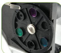
**DIAFRAMMA** - All'interno della rotella del filtro vi sono tre aperture di diametro - (1) 1 mm, (3) 3 mm e (6) 6 mm, le quali limitano la quantità di luce che arriva al campione. Tali aperture sono parte del diaframma, il quale consente di cambiare le dimensioni del diametro per massimizzare il contrasto, la luce, ecc. L'impostazione predefinita è "6".
