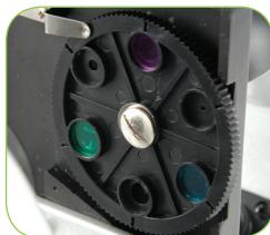
**DIAPHRAGME** – La roue de filtres contient trois diamètres d'ouverture – (1) 1 mm, (3) 3 mm et (6) 6 mm, qui permettent de limiter la quantité de lumière
