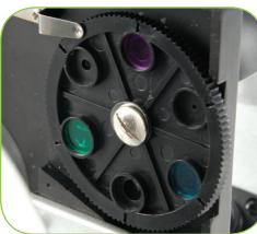
**MEMBRAN** – Innerhalb des Filterrads befinden sind drei runde Öffnungen – (1) 1 mm, (3) 3 mm und (6) 6 mm, welche die Lichtmenge begrenzen, die durch die Probe geht. Diese Öffnungen sind Teil der Membran, mit der Sie die Durchmessergrößen ändern können, um Kontrast, Helligkeit usw. zu maximieren. Die Standardeinstellung ist „6“.
