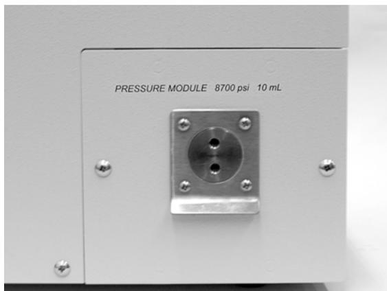
**Figure 3** Pressure module
