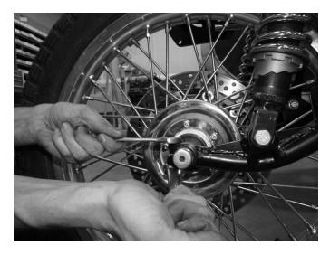
**Step 3**Loosen the axle pinch bolt.
