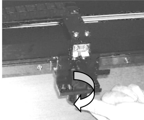
Fig. 7-9 Uninstall Focus Lens
