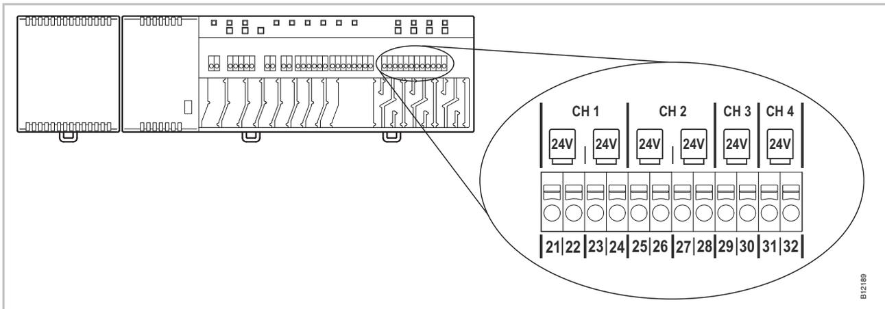
Fig. 22: Connect thermal actuators
