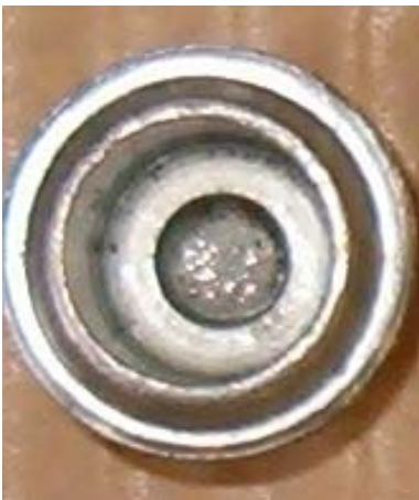
Filterkop ved benzinhanen.
