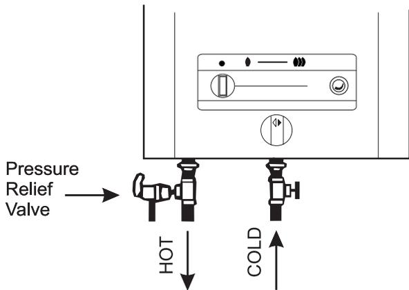
**Fig. 4 - Pressure Relief Valve**
