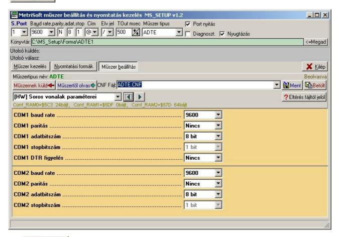
The Müszertől olvas button is used to enter the configuration and read the parameters from the instrument.
