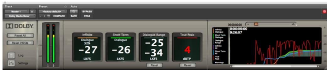
**Figure 3-6** Dolby Media Meter Plug-In Window
