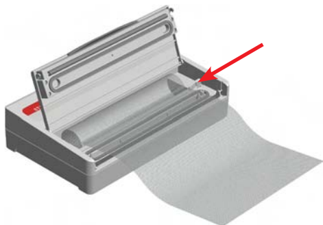
Slika 4: Folijo odrežite z vgrajenim rezilom.
