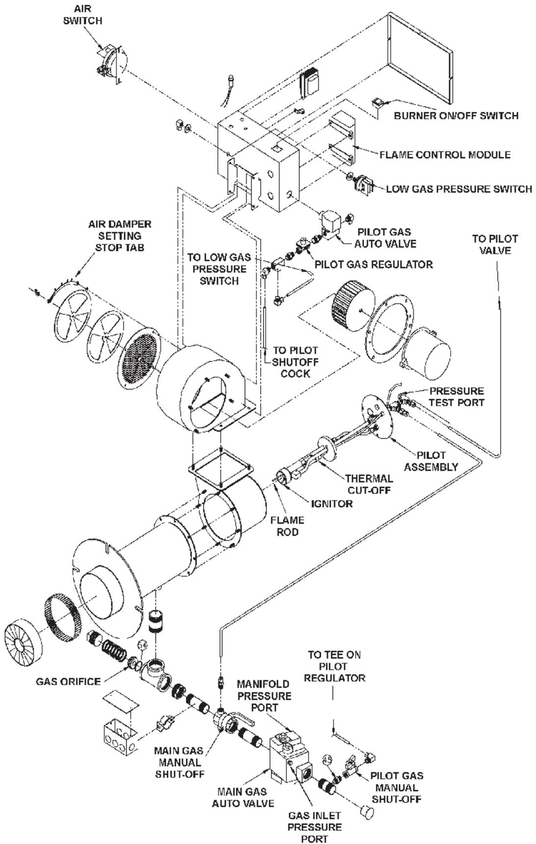
PREMIX LOW NO<sub>x</sub> BURNER - EXPLODED VIEW FOR BTP MODELS
