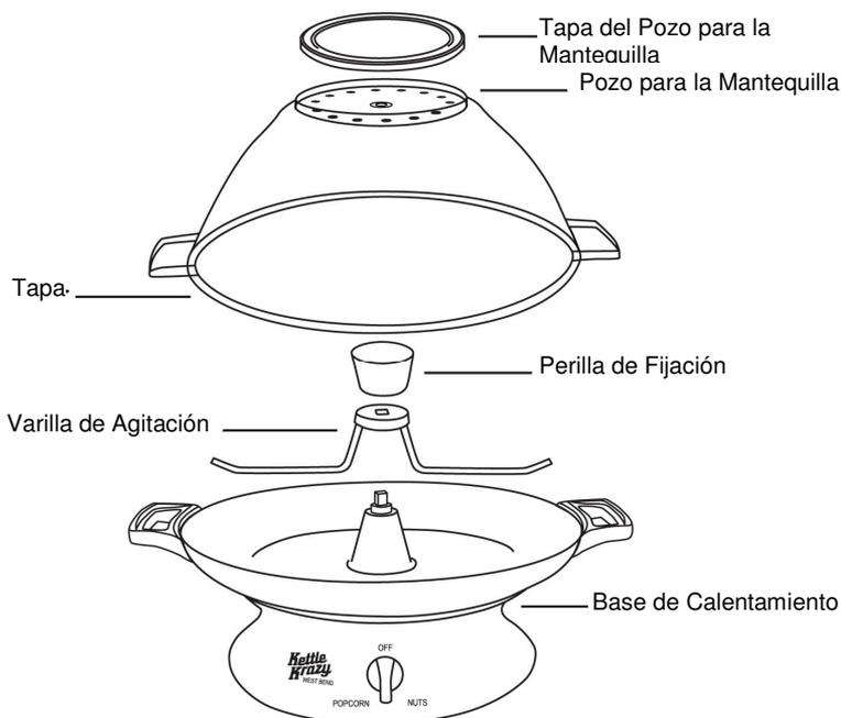
Siga las instrucciones en la sección "Limpieza de su Máquina Kettle Crazy™". **Nota:** Revise periódicamente las asas para asegurarse de que estén completamente apretadas; deberán estar bien fijadas y no bambolear. **NO SOBREPRIETE, PUESTO QUE PUEDE DAÑAR LA ROSCA DE LOS TORNILLOS O ROMPER EL ASA.**
