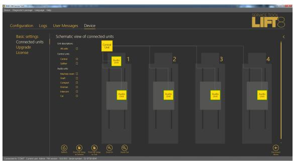
Figure: Zobrazení 4 kabinových jednotek na interním splittru
