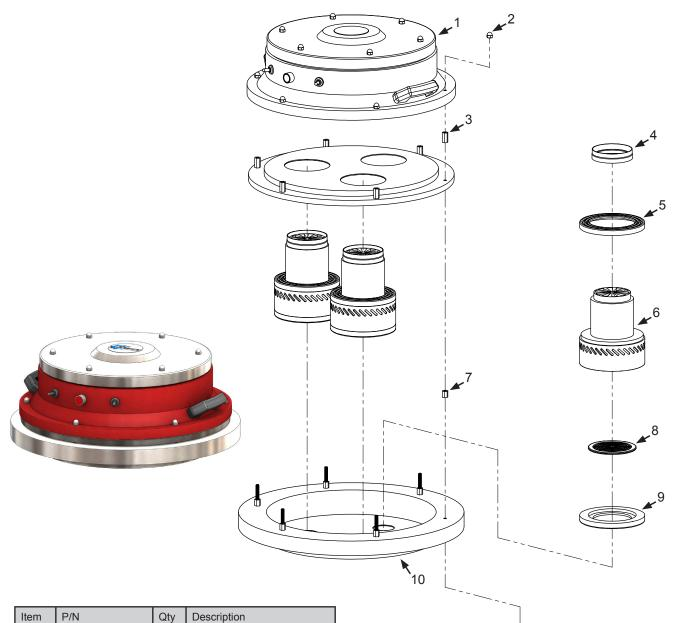
1 MV.1.001 6 Acorn nut MV.1.002 2 1 Motor housing cover MV.1.003 6 3 Hex spacer (long) MV.1.004 3 4 Motor rubber ring (upper) 3 5 MV.1.005 Motor rubber ring (middle) 6 MV.1.006 3 Motor 7 MV.1.007 6 Hex spacer (short) MV.1.008 3 8 Plastic net 3 9 MV.1.009 Motor rubber ring (lower) 1 10 MV.1.010 Motor table 11 MV.1.011 6 flat washer MV.1.012 6 12 Hex head cap screw
