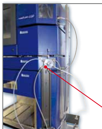
Waste tube: valve (port n°6)
