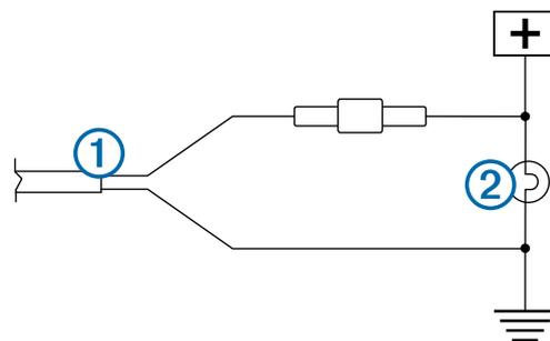
**NOTA:** il collegamento del trasmettitore a una fonte da 12-24 V CC fissa (come un DRL) invece che a una lampadina della retromarcia, richiede di attivare manualmente il trasmettitore tramite un interruttore. Se lasciato acceso, il trasmettitore potrebbe consumare la batteria del veicolo.
