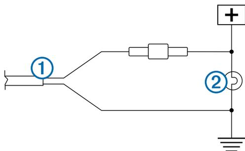
**REMARQUE :** si vous reliez l'émetteur à une source d'alimentation permanente de 12-24 V c.c. (aux feux de circulation, par exemple) et non pas aux feux de marche arrière, vous devrez allumer et éteindre l'émetteur manuellement. Si vous le laissez allumé en permanence, l'émetteur risque de décharger la batterie de votre véhicule.
