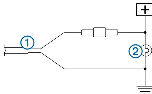
**UWAGA:** Podłączenie nadajnika do zawsze włączonego źródła zasilania prądem stałym o napięciu 12–24 V (np. lampy światła do jazdy dziennej), zamiast do lampy świateł cofania, wymaga ręcznego włączenia zasilania nadajnika przez użytkownika. Pozostawienie włączonego nadajnika może spowodować całkowite rozładowanie akumulatora pojazdu.
