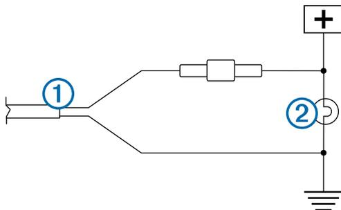
**HINWEIS:** Wenn Sie den Sender mit einer dauerhaft mit Strom versorgten 12- bis 24-Volt-Gleichstromquelle verbinden und nicht mit einem Rückfahrlicht, müssen Sie die Stromversorgung des Senders manuell herstellen. Der Sender kann zu einem Entladen der Fahrzeugbatterie führen, falls er nicht ausgeschaltet wird.
