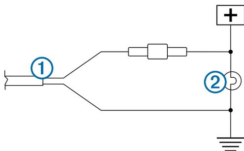
**NOTA:** se ligar o transmissor a uma fonte de alimentação permanente de 12 a 24 V CC (por exemplo, às luzes de circulação diurna), e não à luz de marcha atrás, terá de ligar e desligar manualmente a alimentação do transmissor. Se deixar o transmissor ligado, este poderá descarregar a bateria.
