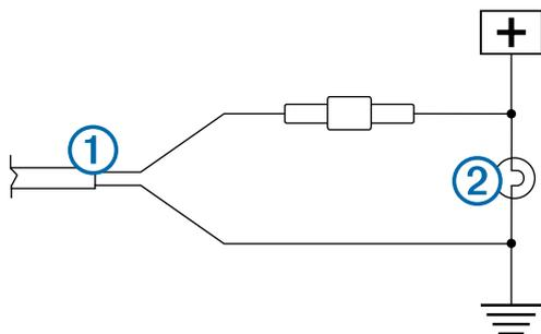
**OBS!** Om du ansluter sändaren till en strömkälla med 12–24 V likström (t.ex. en varsellampa) istället för en backlampa måste du sätta på strömmen till sändaren manuellt. Sändaren kan ta slut på batteriet i ditt fordon om den lämnas påslagen.
