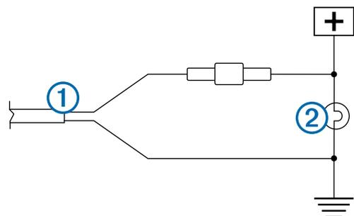
**NOTA:** si conectas el transmisor a una fuente estable de 12-24 V de CC (como una lámpara de circulación diurna) en vez de a una luz de marcha atrás deberás desactivar de forma manual la alimentación al transmisor. El transmisor puede agotar completamente la batería del vehículo si lo dejas encendido.
