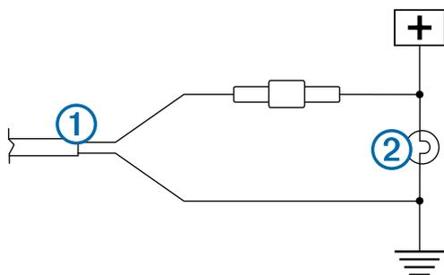
**BEMÆRK:** For tilslutning af transmitteren til en konstant 12-24 V DC-kilde (f.eks. køreløst) i stedet for bakygten skal du koble strøm til transmitteren manuelt. Transmitteren kan dræne køretøjets batteri, hvis den forbliver tændt.
