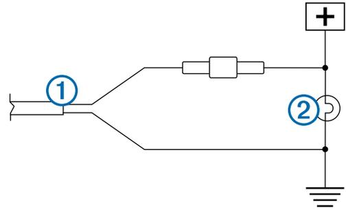
**HUOMAUTUS:** kun lähetin liitetään pysyväan 12-24 VDC:n virtalähteeseen (kuten huomiovaloon) eikä peruutusvaloon, virta on kytkettävä manuaalisesti lähettimeen. Lähetin voi tyhjentää ajoneuvon akun, jos se jätetään päälle.
