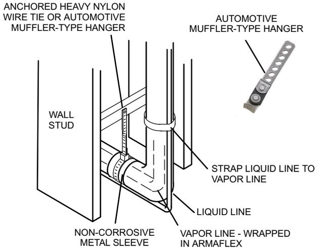
**REFRIGERANT LINE SET — INSTALLING HORIZONTAL RUNS**
