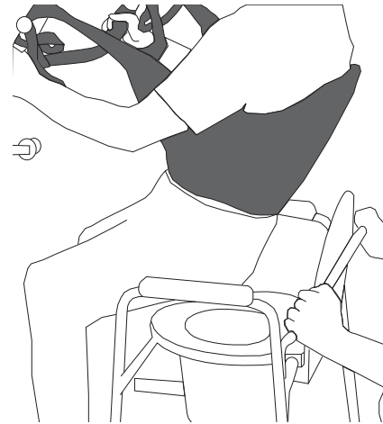
DETAIL “B” - UNHOOKING SLING
