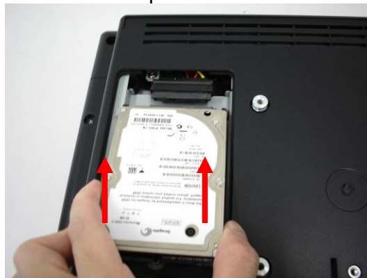
b. Open the HDD door
