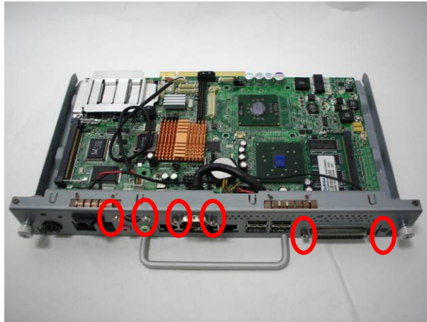
a. Remove the hex nuts *6
