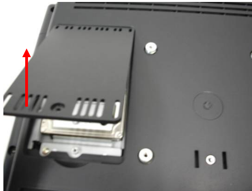
b. Open the HDD door
