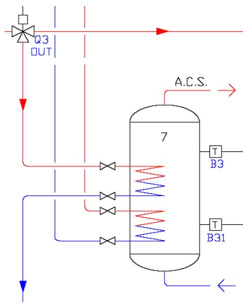
**Figure 51** DHW components
