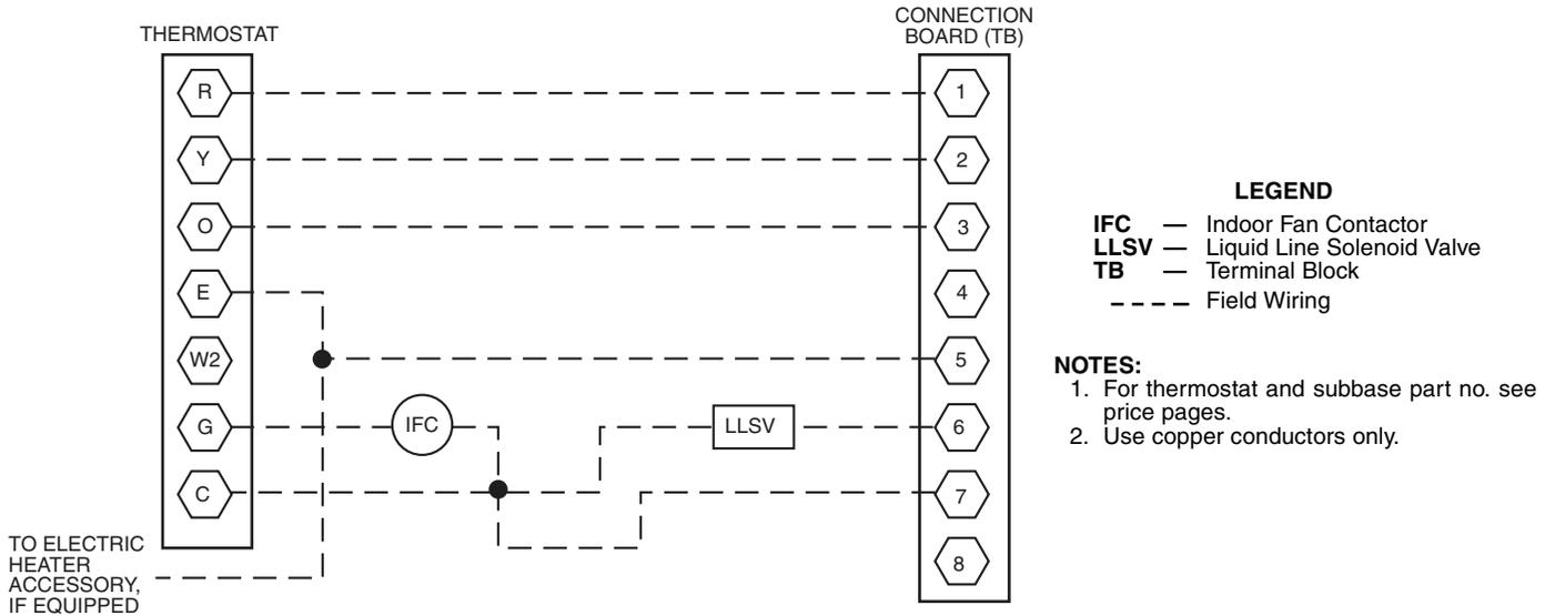
Fig. 10 — Wiring Diagram — 575C090,120; 230-3-60 Units
