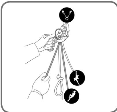
Manuelles Brmsgerät nach EN 15151-2 zur Sicherung eines Vor- bzw. Nachsteigers, zum Sichern mit Seilumlenkung (Topropen) und zum Ablassen bzw. Abseilen beim Klettern.
