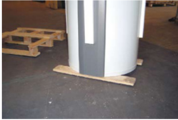
6. Produkt auf dem Boden mit 2 Holzstück-
