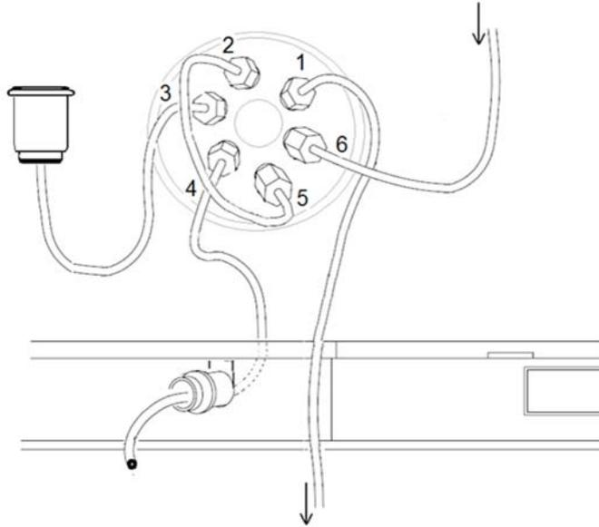
**Figure 32** Autosampler Valve
