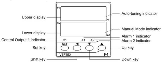
• PV Display : Displays the process Value or parameter index code or error code
