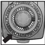
**Para limpiar la tapa del motor y las costillas de entrada:** Use una aspiradora doméstica común. No use agua para limpiar estas partes del Circulador de Aire.
