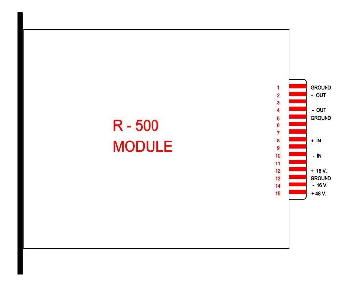
FIG. 3 500 Series module edge connector
