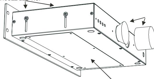
3 UTILISEZ LES CYLINDRES DE MOUSSE POUR OBTURER COMPLÈTEMENT ET BLOQUER L'AIR DANS LES TROUS SITUÉS À L'ARRIÈRE DE L'APPAREIL.
