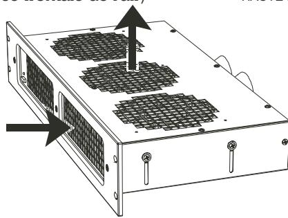
1 DÉVISSEZ LES VIS LATÉRALES DE MAINTIEN DU BLOC DES VENTILATEURS, ET PLACEZ-LES EN POSITION HAUTE (TOP). REVISSEZ LES VIS.
