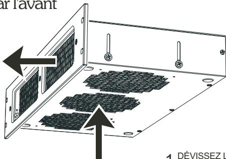
1 DÉVISSEZ LES VIS LATÉRALES DE MAINTIEN DU BLOC DES VENTILATEURS, ET PLACEZ-LES EN POSITION BASSE (BOTTOM). REVISSEZ LES VIS.
