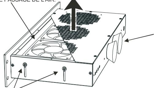
3 UTILISEZ LES CYLINDRES DE MOUSSE POUR OBTURER COMPLÈTEMENT ET BLOQUER L'AIR DANS LES TROUS SITUÉS À L'ARRIÈRE DE L'APPAREIL.
