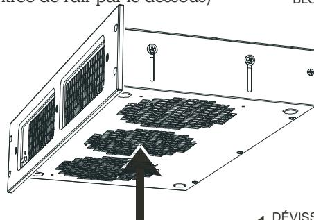
2 RETIREZ LE CAPOT EN PLASTIQUE SUPÉRIEUR POUR LIBÉRER COMPLÈTEMENT LES OUÏES INFÉRIEURES, ET PLACEZ LE BLOC DE MOUSSE DERRIÈRE LA FAÇADE POUR BLOQUER LE PASSAGE DE L'AIR.
