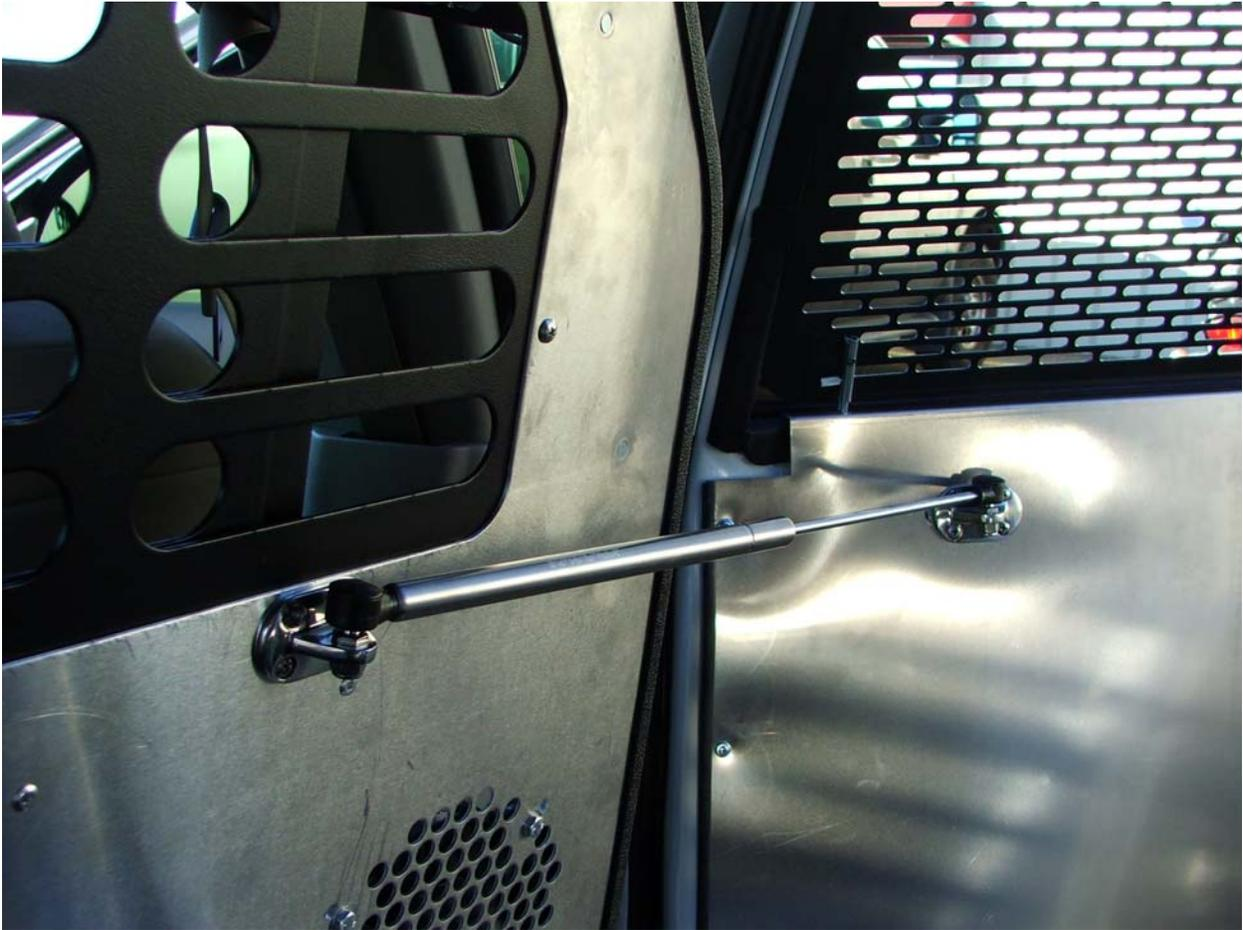
***NOTE: LOCATE THE PUSH ROD SO THAT IT IS NOT IN A DANGEROUS POSITION FOR THE K9'S ENTRANCE AND EXIT OF THE VEHICLE. THE PHOTO ABOVE SHOWS A SUGGESTED LOCATION FOR MOUNTING THE GAS PUSH ROD.***
