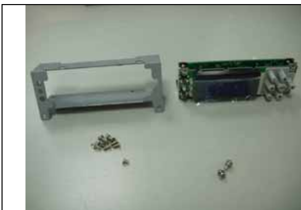
Fig.2-20 Remove EZIO/LCD from EZIO kit
