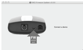
Connect module via mini USB
