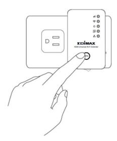
3. Apăsaţi butonul WPS de la punctul de acces wireless în termen de 2 minute pentru a stabili o conexiune. Timpul în care butonul trebuie să fie ţinut apăsat depinde în funcţie de router, anumite routere vor necesita o apăsare scurtă, în timp ce altele au nevoie de o apăsare de 2 secunde sau mai mult.
