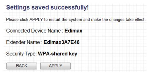
11. După ce faceţi clic pe "APPLY" (Aplicare) extenderul va reporni şi îşi va salva setările. Veţi vedea o pagină cu configurările finale. Calculatorul dumneavoastră va fi deconectat de la extender în acest timp. Pentru a vă reconecta la extender, selectaţi SSID-ul săi din lista de reţele Wi-Fi.
