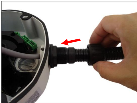
Using Flex Conduit
