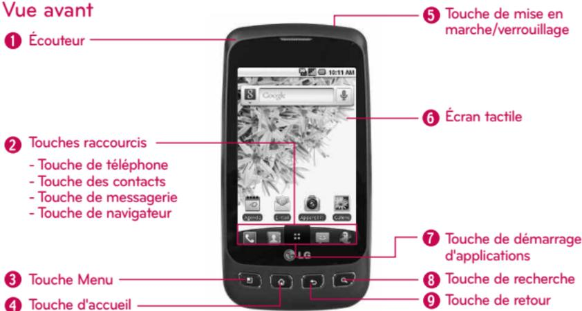
1. **Écouteur** permet d'entendre l'interlocuteur et les messages automatisés.
