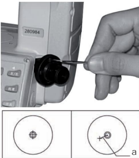
1. Снимите защитную крышку диода лазерного отвеса. С помощью шестигранника переместите лазерную точку на половину расстояния от перекрестья.
