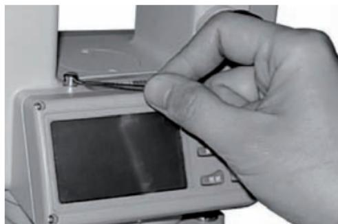
1. С помощью юстировочной шпильки поверните винт, пока пузырек не сместиться на половину расстояния до срединного положения пузырька.
