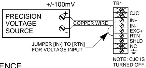
NOTE THAT CJC IS TURNED OFF FOR INPUT CALIBRATION AND TURNED ON FOR TEMPERATURE REFERENCE CALIBRATION.
