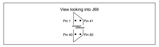
FIGURE 4-1 J69 PIN ORIENTATION
