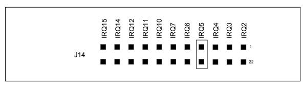
FIGURE 2-3 INTERRUPT JUMPERS (DEFAULT SETTING)
