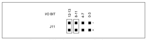
FIGURE 2-4 I/O CONFIGURATION JUMPERS (default setting)
