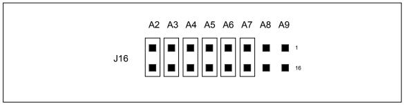
FIGURE 2-2 ADDRESS SELECT JUMPERS (DEFAULT SETTING)
